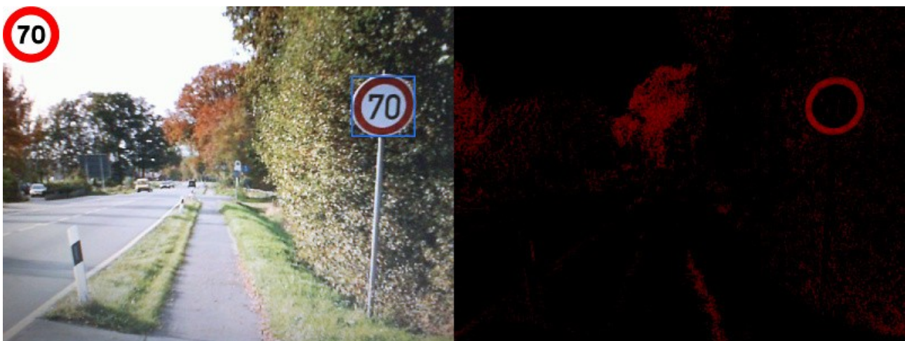
Abb. 2: Kamerabild (links) und nach Rotwert gefiltertes Bild (rechts, zum besseren Erkennen gammakorrigiert)
